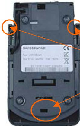
Um das Gehäuse-Oberteil vom Unterteil trennen zu können, öffnen Sie auf der Geräteunterseite die beiden Arretierungen links und rechts und je eine auf der Gehäusevorderseite und -rückseite.
