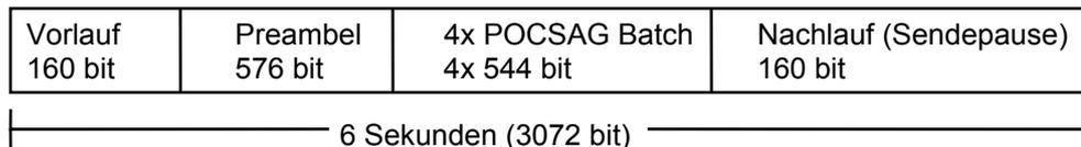
Struktur eines POCSAG Batches:
