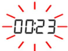
In den rechten beiden Digits (Stellen) werden die Sekunden gezählt. Dabei blinken die Sekunden bei jedem Wechsel auf. Durch das Blinken wird eine Separation von der linken 7-Segmentanzeige erreicht, welche als Minutenzähler dient. Total sind also in diesen Anzeigemodus 60 Minuten "59:59" möglich.
