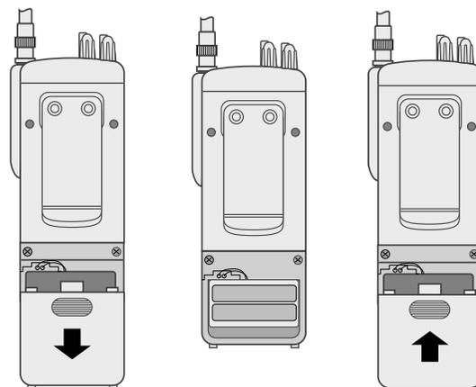
2. Auf der Rückseite den Akkufachdeckel (auf den geriffelten Bereich drücken) in Pfeilrichtung aufschieben!
