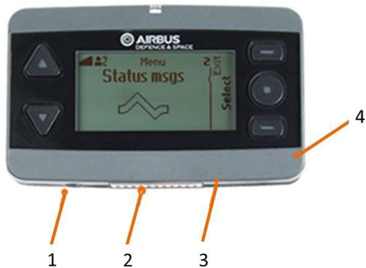
Abbildung 1 Externe Schnittstellen des P8GR
