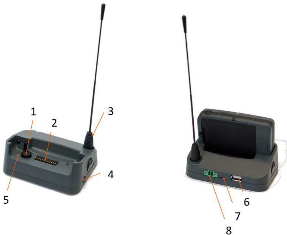
Abbildung 2 Externe Schnittstellen der Home-Station PHS-1
