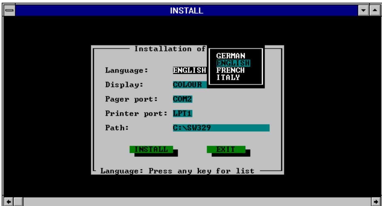
Auf dieser Oberfläche sind einige Vorbedingungen zu beantworten. Es kann die Sprache und die Displayfarbe für den Monitor gewählt werden, der Com-Ausgang für den Programmierer PG 329 und ebenfalls für einen Printer eingestellt werden, sowie die Schnittstelle bestimmt werden. Wichtig ist hierbei die nächste Zeile mit dem Befehl "Installieren". Er ermöglicht das Ablegen der gewählten Daten auf ein Laufwerk Ihrer Wahl.
