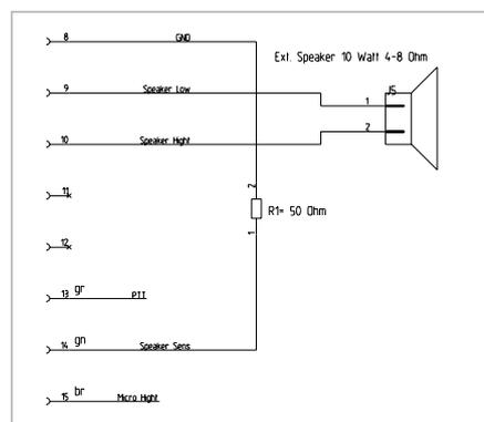
\* *Diese Anschlüsse dürfen nur zum Lautsprecher geführt werden und nicht gegen masse verbunden werden*
