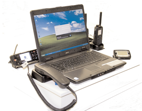
Zu Testzwecken verfügt das Projekt Digitalfunk BOS Hessen über eine »Alarmierungsstation«. Zu den Komponenten zählen (v.l.) das Bedienteil des festeingebauten Funkgeräts (FRT) mit Handapparat und ein Personalcomputer. Ganz rechts ist der Prototyp eines Pagers zu sehen.
