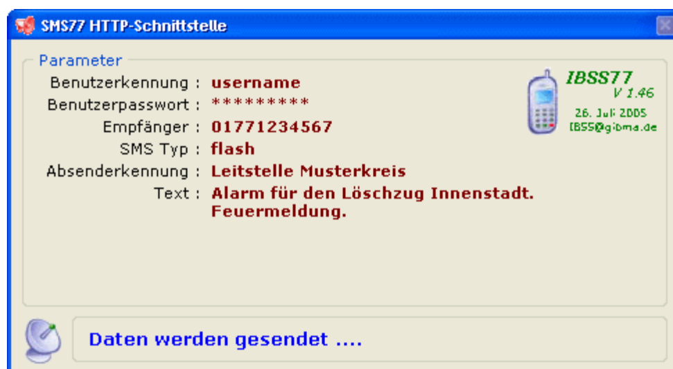
Bild 4 : Eine SMS wird gerade gesendet und auf die Antwort des Gateways gewartet.
