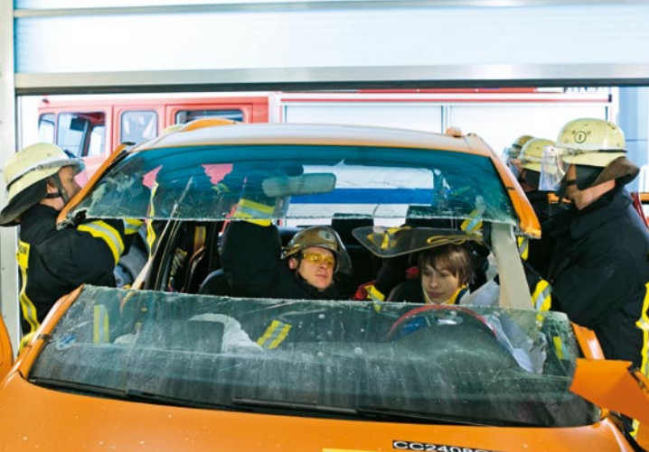
Feuerwehrmänner entfernen bei einer ADAC-Vorführung das Autodach, um den Insassen zu befreien – die Rettungskarte hilft dabei entscheidend
